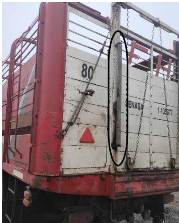
Figura 9. Está marcado uno de los rodillos giratorios externos. La función de estos es absorber el impacto de los golpes laterales cuando el animal sube o baja del camión. Adecuado según la Resolución SENASA 557/2024.
