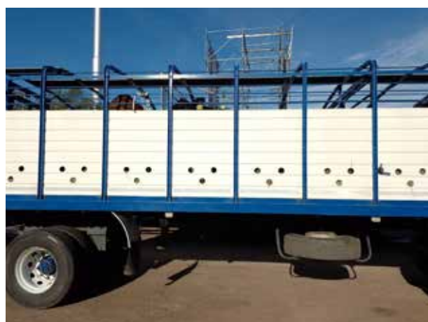
Figura 14. Aberturas de ventilación circulares en dos filas y en una fila. Adecuado según la Resolución SENASA 557/2024.
