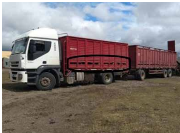
Figura 13. Ventilación del transporte adecuado según la Resolución SENASA 557/2024.
