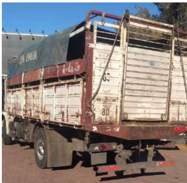
Figura 16. Ausencia de aberturas de ventilación a 40 cm del suelo. Si bien tiene ventilación arriba, no es adecuada según la normativa. Inadecuado según la Resolución SENASA 557/2024.
