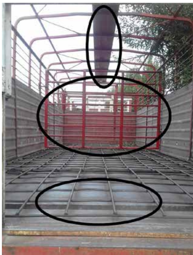
Figura 17. Pasarela superior. También se ven las separaciones internas para apartar distintas categorías y una malla cuadriculada adecuada según la Resolución SENASA 557/2024.
