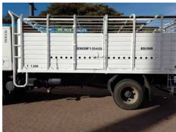
Figura 15. Aberturas de ventilación circulares en dos filas y en una fila. Adecuado según la Resolución SENASA 557/2024.
