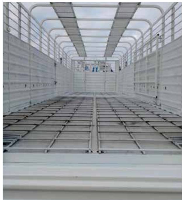
Figura 2. Pisos adecuados según la Resolución SENASA 503/2022. Si bien estas mallas cuadriculadas son acordes según la normativa, el hecho de colocar las nervaduras longitudinales por sobre las transversales, o al revés, puede generar espacios en los que un animal de pequeño tamaño puede engancharse y tropezar. Además, con el peso de los animales pueden doblarse. Lo ideal sería hacer que ambas nervaduras o varillas se encuentren soldadas al mismo nivel y no una sobre otra.
