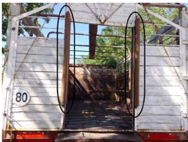
Figura 10. Marcados el rodillo giratorio interno y el externo, a la misma altura. Adecuado según la Resolución SENASA 557/2024.
