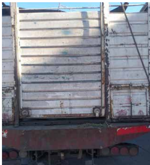
Figura 12. Ausencia de rodillos giratorios externos. Inadecuado según la Resolución SENASA 557/2024.
