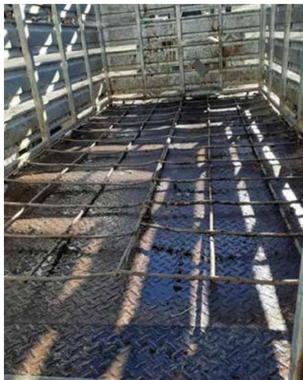
Figura 5. Pisos inadecuados según la Resolución SENASA 503/2022. Con el tiempo, cuando las mallas cuadriculadas no están bien encastadas, pueden terminar como en la fotografía y generar saliencias que dañen a los animales.
